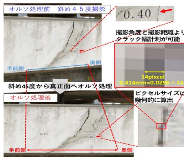
図-2 斜め方向からの寸法計測の例
