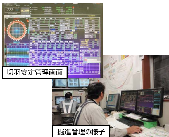
図-1 KSCS 切羽安定管理画面および掘進管理の様子
