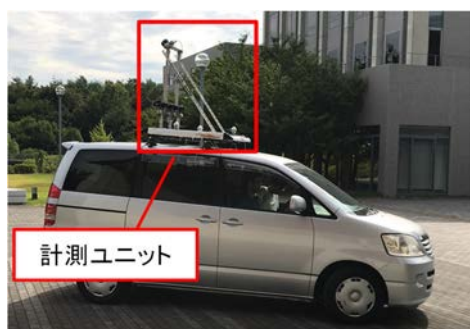
図-1 既存の車両搭載センシングユニット
