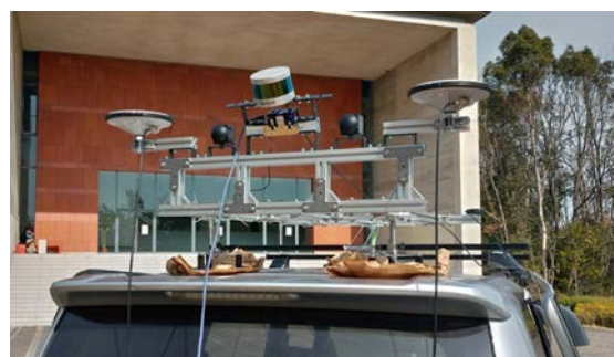
図-4 車体に設置したセンシングユニット
