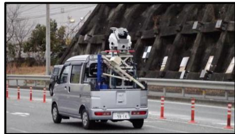
図-2 法面を対象に MMS 測量を行っている様子
