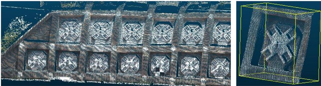
図-1 アンカー設置法面の点群データ
