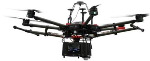
図-2 グリーンレーザスキャナを搭載したドローンの概観
