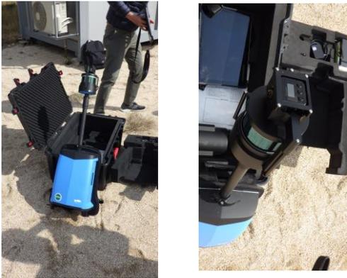
図-1 SALMを導入した携帯型レーザ計測システムの概要
