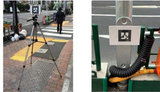
a) 三脚を用いたマーカー設置 b) 既往構造物を用いたマーカー設置
