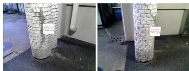
図-11 曲面形状の柱に対する AR 表示結果 (夜)
