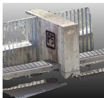
図-5 作成した 3D モデル (柱状構造物)
