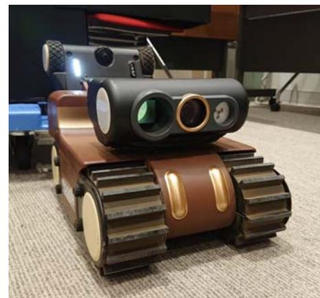
写真-5 床下点検ロボット
