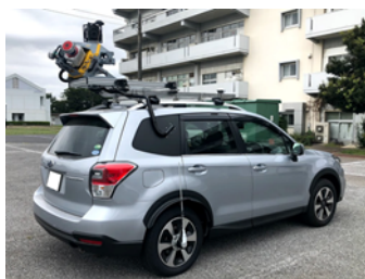
図-2 使用したMMS(Trimble MX9)
