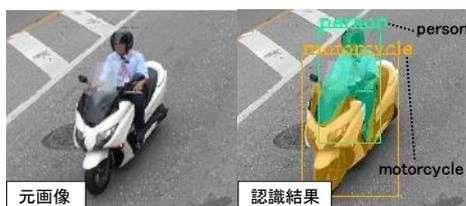
図-3 Instance Segmentationによる物体認識結果例
