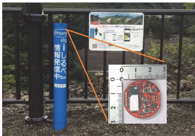
図-1 現場見学者向けビーコン 1) 2) 3)
