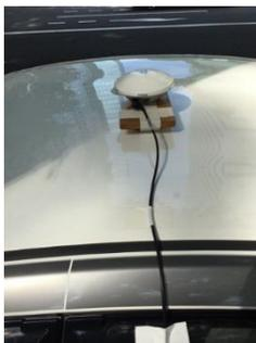
図-3 アンテナ設置状況
