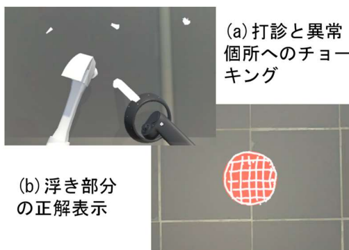
図-6 打音検査体験時におけるチョーキングと異常箇所表示
