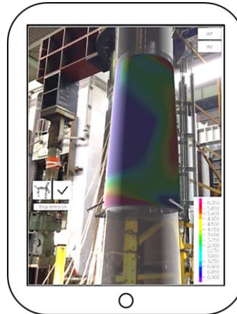
図-5 試験体への AR 重畳 (CIMモデル・解析結果)
