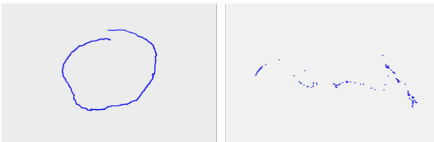
図-7 推定された撮影軌道(左：低速移動時，右：高速移動時)
