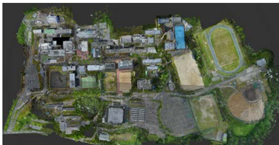
図-1 キャンパス全体の UAV 写真点群
