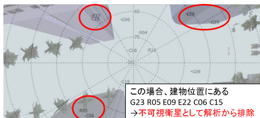
図-2 衛星配置と構造物の合成図
