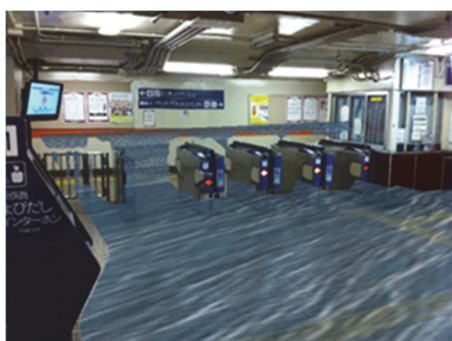
図 1：地下空間での予測浸水の AR 表示 4)
