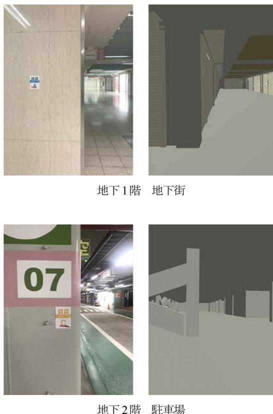
図-3 地下街、地下駐車場の3次元モデルを表示し、バーチャルカメラ位置確認している様子
