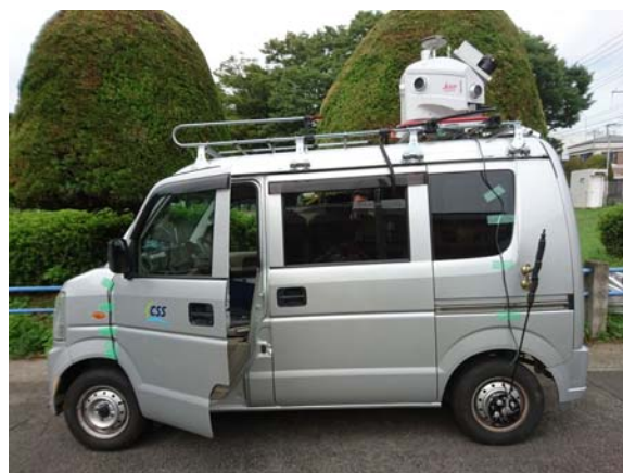
写真-1 計測車とMMS車載状況
