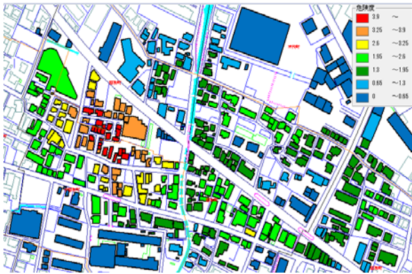
図-4 対象地区における建物の危険度
