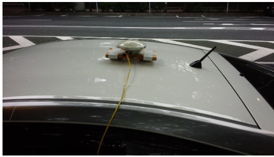
図-1 実験車両のアンテナ設置状況
