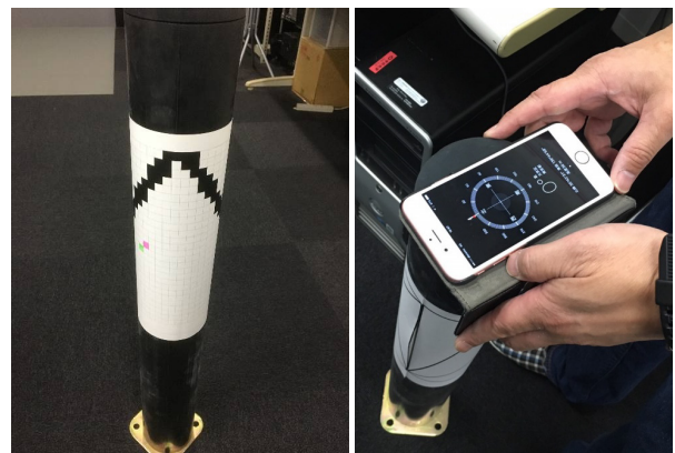
図-9 情報化ポールと電子コンパス
