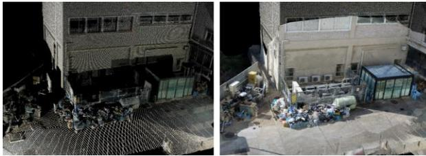
図-7 スキャナの3次元点群 (左) と統合結果 (右)
