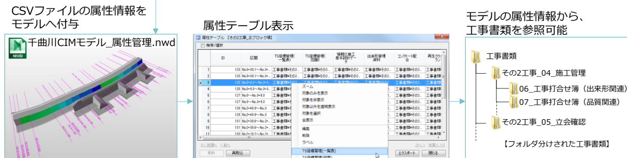
図-1 3次元モデルにおける属性情報の構成
