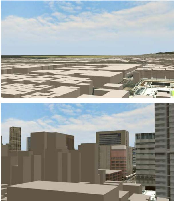
図-2 VR空間における従来までの建物モデル<sup>4)</sup>(上)と高解像度衛星写真<sup>5)</sup>を用いて解析した建物モデル(下)との比較
