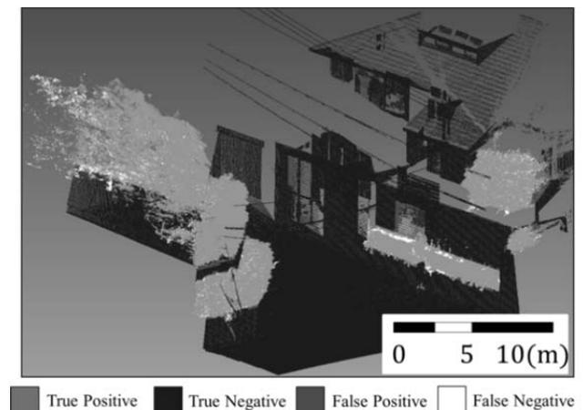
図-2 点群分類精度
