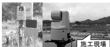
図-4 地上設置型レーザスキャナの計測風景
