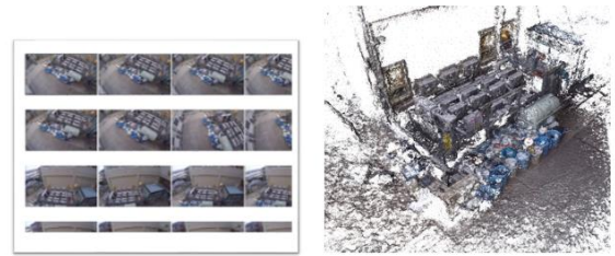
図-2 画像群（左）とSFMによる3次元点群（右）
