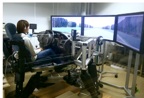
図-1 路面評価型 DS による試験状況
