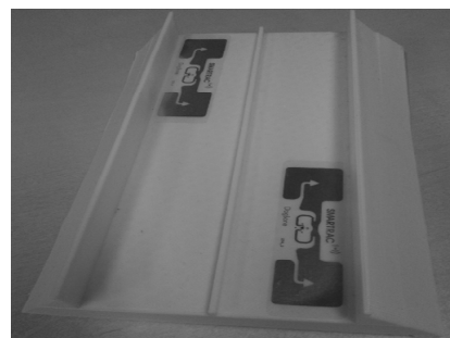
図-4 RFID を貼付した3次元プリンタモデル
