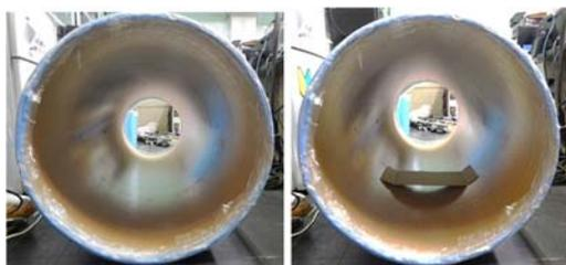
図-4 変状のない状態 (左) と変状がある状態 (右)
