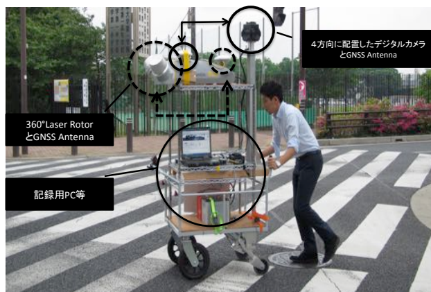
写真-1 手押し台車型MMSの概要と計測風景
