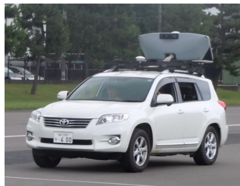
図-1 モバイルマッピングシステム (MX8)
