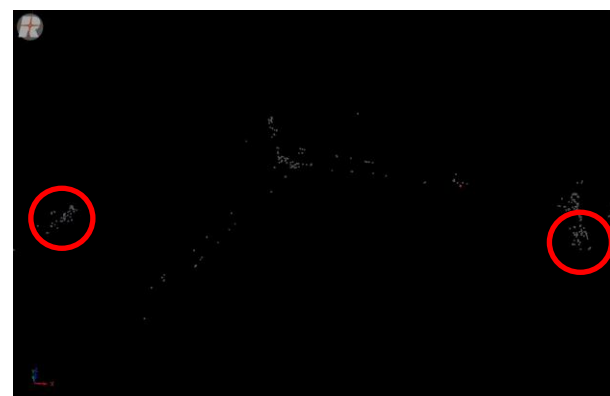
図-5 抽出後（反射強度値+RGB平均値+高さ情報）
