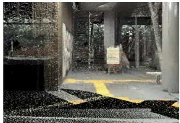
図-4 ノイズが多く含まれた点群データ
