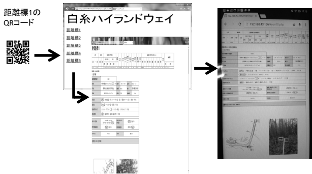
図-3 QRコードからの点検データの呼び出し
