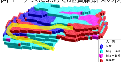
図-2 3次元GISを用いた賦存量管理モデルの例
