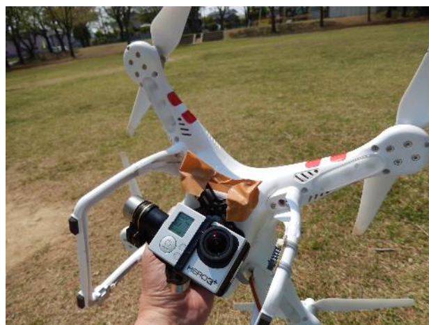
写真-6 ブラシレスジンバルとデジタルカメラ(Gopro HERO3+)を取り付けた Phantom2
