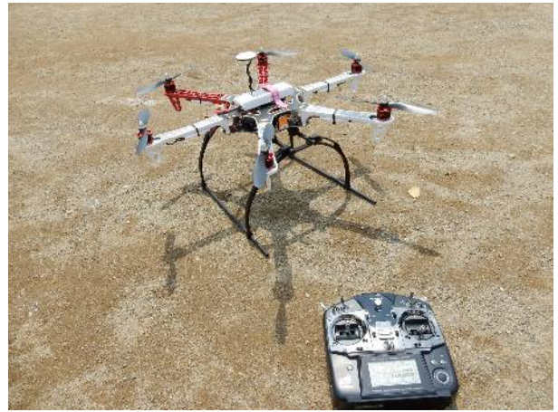
写真-5 ローターマルチコプター(DJI 社 F550)
