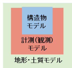
図-2 河川CIMモデルの構成
