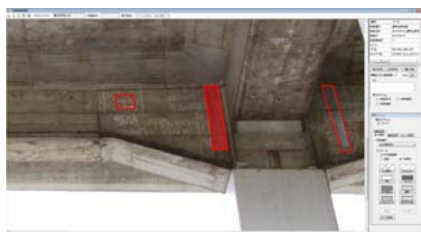
図-5 変状・補修図形入力
