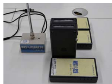
真-1 センサおよび 微弱無線アンテナの外観
