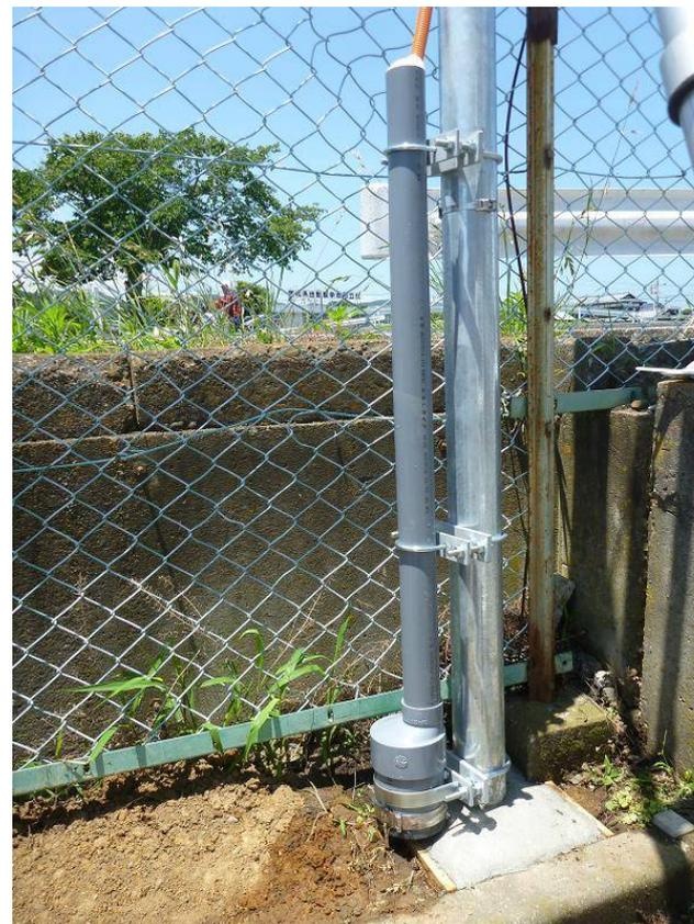
図-9 水位センサ(路面取り付け時)
