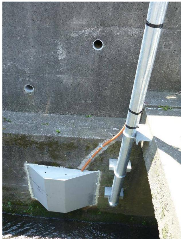
図-8 水位センサ(河川取り付け時)
