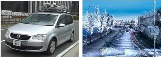
図－１ GPS 移動計測装置(左)と点群データ(右) 6)
