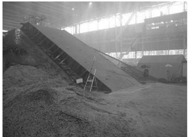
図-1 斜面崩壊実験施設(施設遮蔽)
