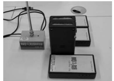
写真-1 センサおよび微弱無線アンテナの外観
