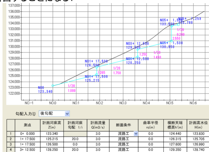
図-4 溪流保全工 縦断計画の例
