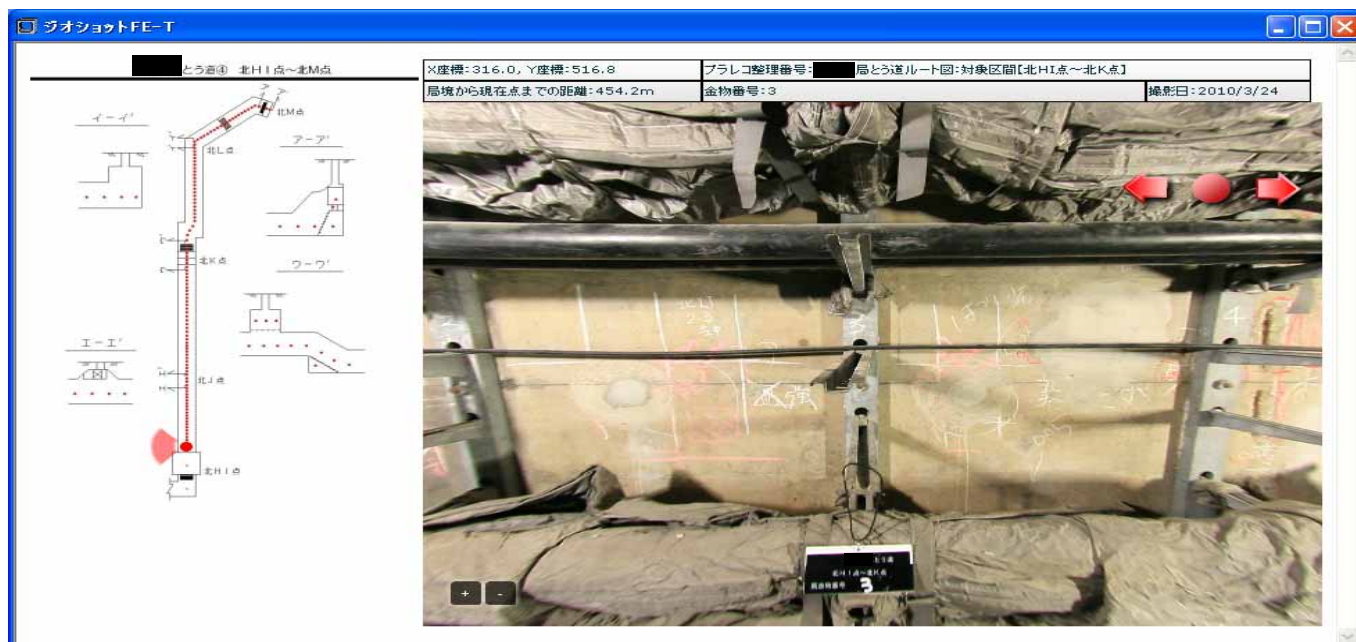
図-6 通信用トンネルでの「ジオショットFE-T」
