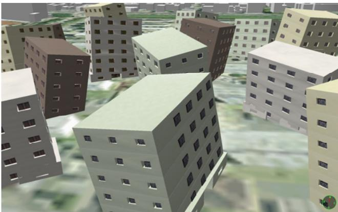
図-10 自動生成した色々な方向に傾斜した倒壊ビルが存在する3次元都市モデル
