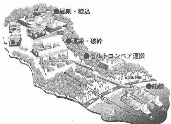
図-1 採土現場の作業概要 3)
