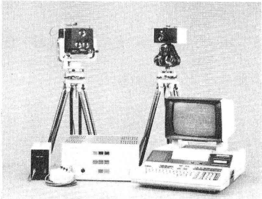
写真-2 作業船位置決め測量装置
